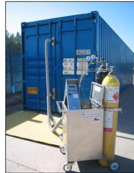
Imagen 16. Fumigación de un contenedor utilizando el Horn Diluphos System en conjunto con el JP System.
