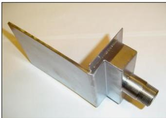
Imagen17. Dispositivo JP System utilizado para la inyección de fosfina con el Horn Diluphos System a través de los burletes de goma de las puertas del contenedor.
